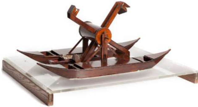
Dredger for cleaning the muddy bed of a canal, model by Luigi Tursini after a drawing of Leonardo da Vinci, Milan, Museo Nazionale della Scienza e della Tecnologia Leonardo da Vinci © Museo Nazionale della Scienza e della Tecnologia Leonardo da Vinci
