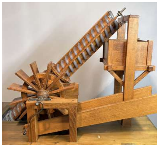
Archimedes' Screw, reconstruction by Dario Noè after a drawing by Leonardo da Vinci, Vigevano, Museo della Roggia Mora © La città ideale - Ecomuseo della Roggia Mora (Mulino di Mora Bassa). Dario Noè
