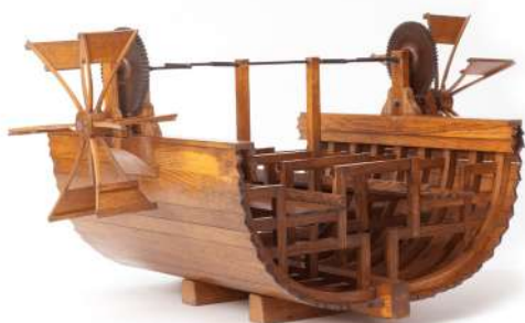
Boat with paddle-wheel propulsion system, reconstruction by Luigi Tursini after a drawing by Leonardo da Vinci, Milan, Museo Nazionale della Scienza e della Tecnologia Leonardo da Vinci © Museo Nazionale della Scienza e della Tecnologia Leonardo da Vinci
